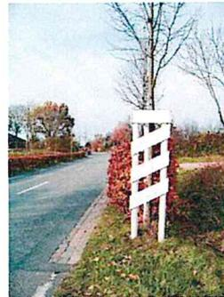
Abbildung 17: Baken als optische Bremsung
